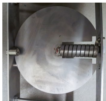
Die automatische Leitblechschwenkwinkel-einstellung erfolgt mittels Bimetallwendeln.
